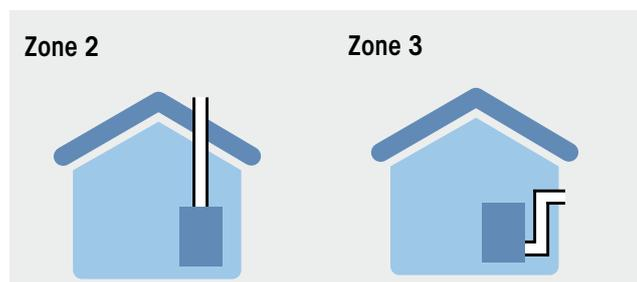
Les appareils non-étanches doivent être installés avec un conduit de fumées conforme au NF DTU 24.1 en respect avec l'arrêté du 22 octobre 1969.
